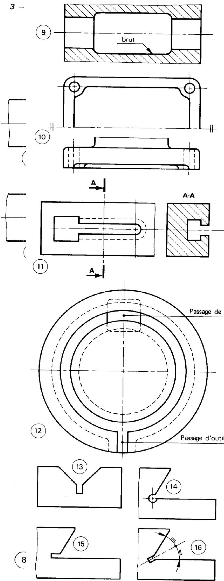
5 - Limiter l'usinage aux parties utiles.
